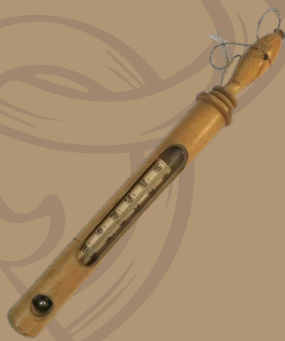
Un thermomètre à mercure dans son étui de protection.
