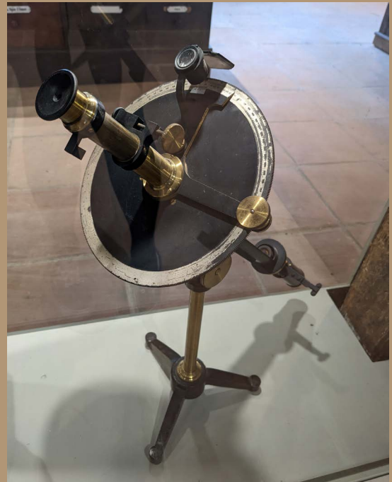
Un polarimètre, dispositif permettant de mesurer la concentration d'une solution optiquement active par la mesure de l'angle de rotation du plan de polarisation de la lumière polarisée.
